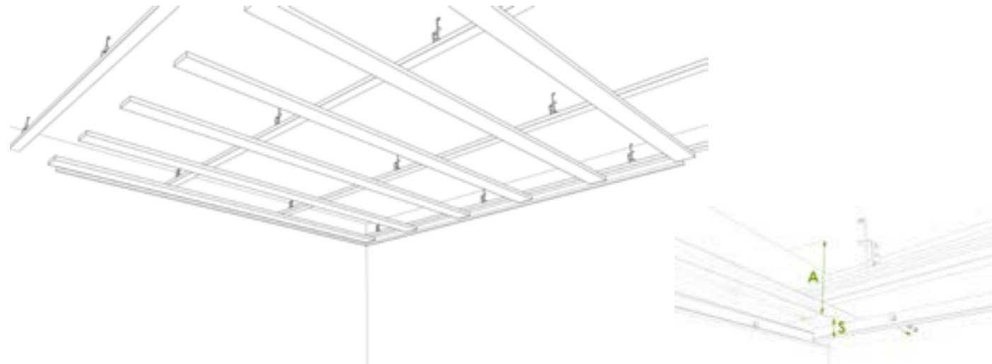
Abb. 3a Unterkonstruktion mit Wandanschlusswinkel
